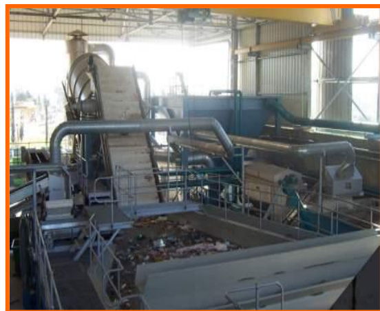
Figura 6. Impiant klasifikues i mbetjeve mekaniko-biologjike
