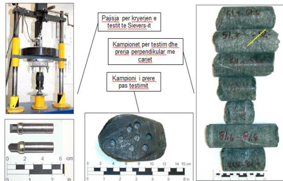
Figura 3 Pajisja e testimit dhe një kampion përfaqësues i testuar për të përfuar vlerën e Sieversit
